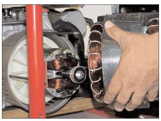
Step 6 - Remove the rotor bolt.
