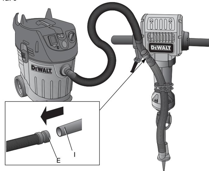
Enfoncez fermement l'embout du tuyau de l'aspirateur (I) dans la buse de raccordement (E). Pour un raccordement plus sécuritaire, utiliser le système de connexion AirLock.
