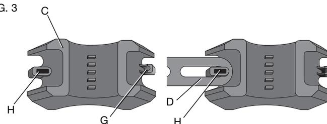
4. Placez le dispositif de fixation (C) sur le boîtier avant de l'outil et encerclez ce dernier avec le collier réglable (D).
