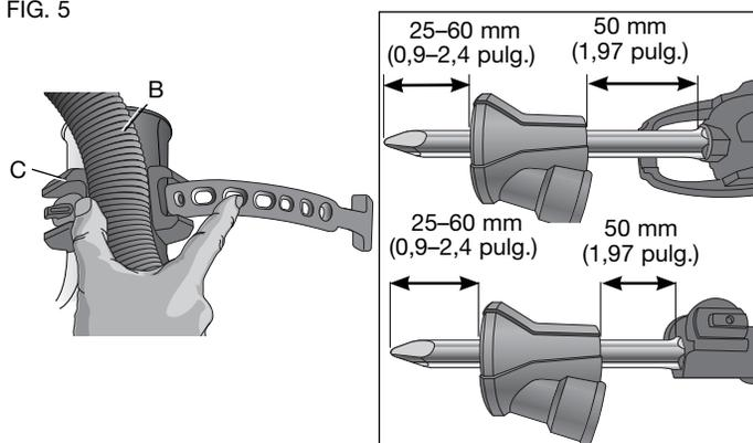
7. Hale para apretar la correa ajustable sobre la manguera y engánchela en el gancho de soporte (H) para fijarla en su lugar. Cerciérese de que el soporte, la manguera y la correa ajustable estén completamente asegurados a la herramienta.
