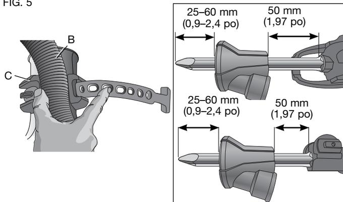
7. Resserrez soigneusement le collier réglable sur le tuyau et accrochez-le à la fixation (H) pour arrimer l'ensemble.
