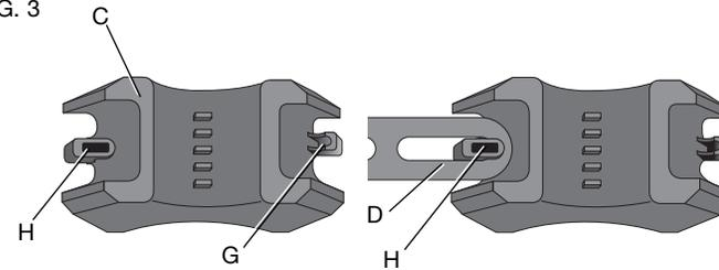
4. Coloque el soporte (C) sobre la carcasa frontal de la herramienta y envuelva la correa ajustable (D) alrededor de la herramienta.
