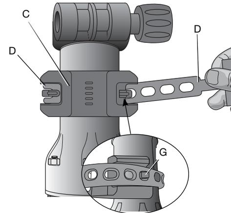
6. Coloque la manguera del sistema de extracción de polvo (B) sobre el soporte (C) dejando suficiente longitud de manguera para garantizar el suficiente movimiento de la boquilla a lo largo del cincel cuando esté en uso.
