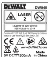
La herramienta DW040 emite un rayo láser visible, como se muestra en la Figura A #1. El rayo láser emitido es un Láser Clase 2 en conformidad con la norma IEC 60825-1 y cumple las normas 21 CFR 1040.10 y 1040.11, excepto en las desviaciones en conformidad con lo establecido en Laser Notice No. 50, del 24 de junio de 2007.
