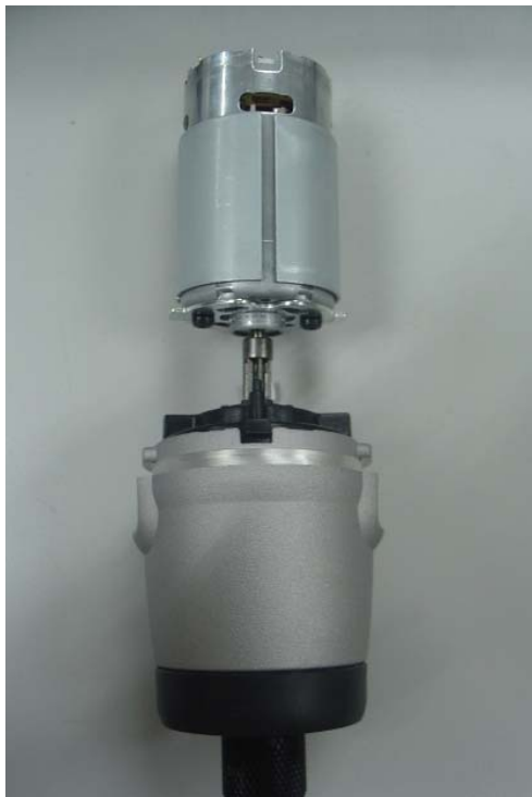
Step 1: push SA Motor into SA Nose Cone .
