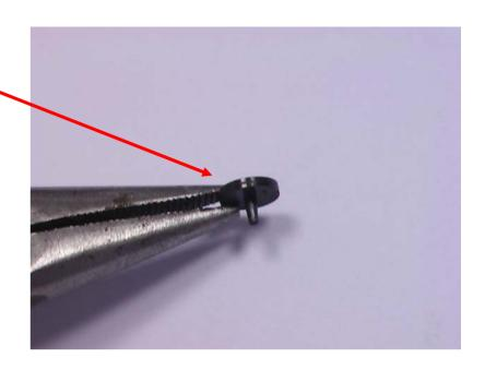
INSERT THE BUTTON BACK INTO THE MODULE
