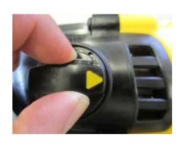
PRESS THE ACTUATOR LEVER AND PUSH THE MODE SELECTOR INTO THE HOUSING
