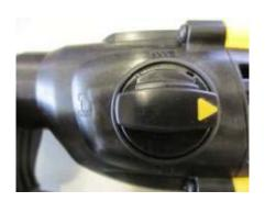
POSITION THE SA SWITCH AS SHOWN (+90 DEGREES CLOCKWISE). THE ACTUATOR PINON ON THE BACK OF THE MODE SELECTOR MUST GO BETWEEN THE TWO SPRING LEGS.
