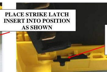
PLACE ANTIVIBE RAIL ASSEMBLY SIDE INSERT INTO POSITION AS SHOWN
