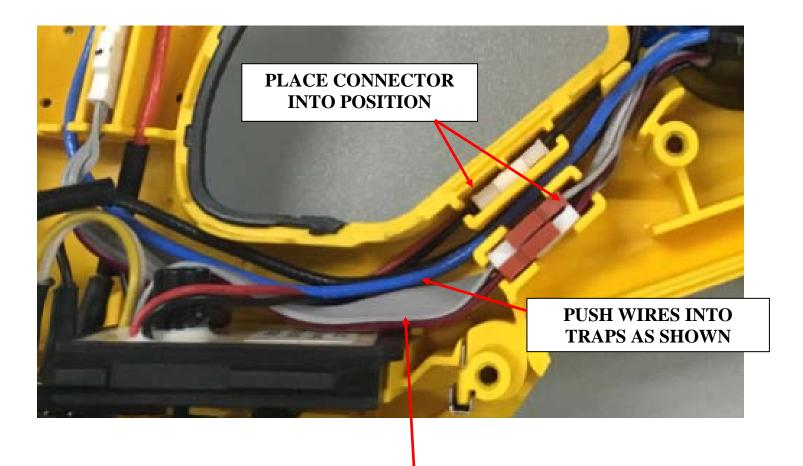
THE MODULE RAINBOW WIRES POSITION AS SHOWN
