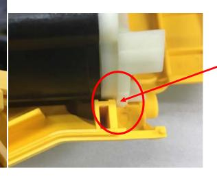
PLACE THE PLATFORM OF MOTOR BAFFER AGAIN THE HANDLE AS SHOWN
