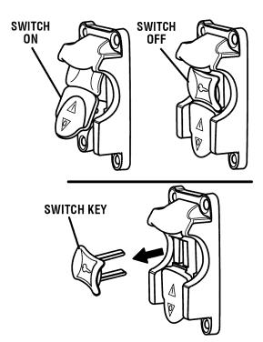
SWITCH IN LOCKED POSITION
