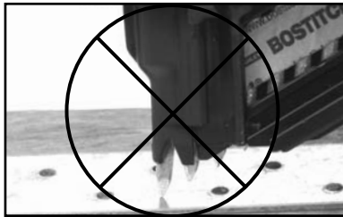
Mauvais placement du clou
