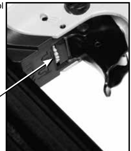
Ajuste de control de fijaciones Dial-A-Depth®
