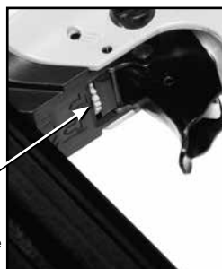
Ajustement de la commande d'attache Dial-A-Depth®
