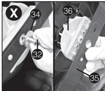
5. La lame ne peut être attachée au ventilateur que dans un sens. Pour réassembler, aligner le trou en D de la lame sur la tige en D du ventilateur en veillant à ce que le texte sur la lame soit tourné vers l'extérieur de la tondeuse.
