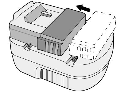
**AVERTISSEMENT :** s'assurer, au moment de ranger ou de transporter le bloc-pile, qu'aucun objet métallique n'entre en contact avec les bornes à découvert du bloc-pile. Par exemple, il faut éviter de placer un bloc-pile sans capuchon dans un tablier, une poche, une boîte à outils ou un tiroir (etc.) contenant des objets tels que des clous, des vis ou des clés, car le bloc-pile pourrait causer un court-circuit et s'endommager, ou risquer de provoquer des brûlures ou un incendie.
