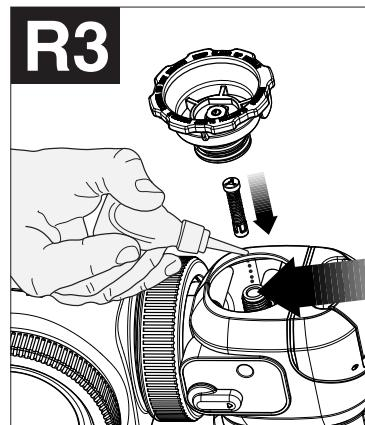
Con el aceite lubricante provisto, aplique unas pocas gotas de aceite por las aberturas de entrada y retorno del pulverizador como se muestra en la **Figura R4**.
