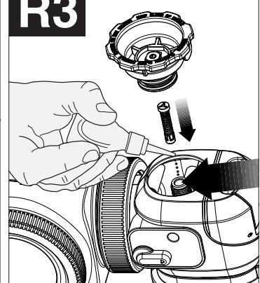
• Utiliser l'huile de graissage fournie et verser quelques gouttes d'huile dans les orifices d'admission et de sortie du pulvérisateur comme le montre la **figure R4**.
