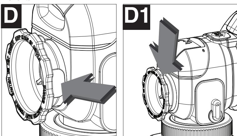
**MISE EN GARDE :** Ne pas comprimer, ni enfoncez le ressort au moment de régler la forme de dispersion du jet en éventail. La buse doit tourner sans se desserrer.
