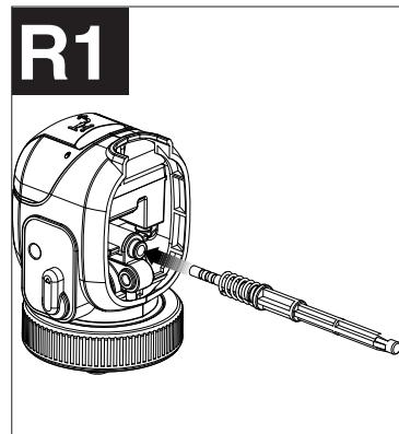
Mientras oprime el botón de liberación, inserte la cubierta delantera con el émbolo dentro del pulverizador hasta que el botón de liberación encaje en su lugar (**Figura R2**).
