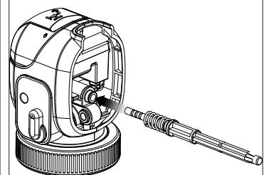
• Enfoncer le bouton de dégagement, insérer le boîtier avant comprenant le piston dans le pulvérisateur, de manière à ce que le bouton s'enclenche en place (**figure R2**).
