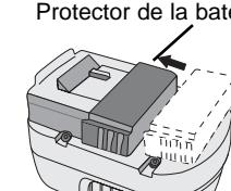
**ADVERTENCIA:** No guarde o transporte la batería de manera que objetos metálicos puedan hacer contacto con las terminales expuestas de la batería. Por ejemplo, no ponga la batería en delantales, bolsillos, cajas de herramientas, estuches de productos, cajones, etc. junto con clavos, tornillos, llaves, etc. sin el protector. La batería puede hacer corto cuando no tenga puesto el protector, ocasionando incendios o quemaduras, o daños a sí misma.
